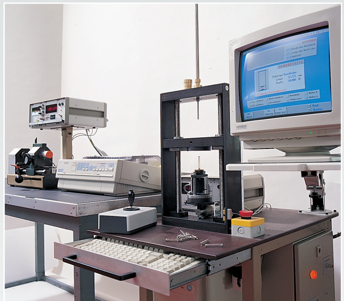
Vollautomatische Federprüfmaschine (Druck-Zugkraft und Drehmomentmessungen) Machine de contrôle pour ressorts entièrement automatique (force de compression/traction et mesures du couple)
